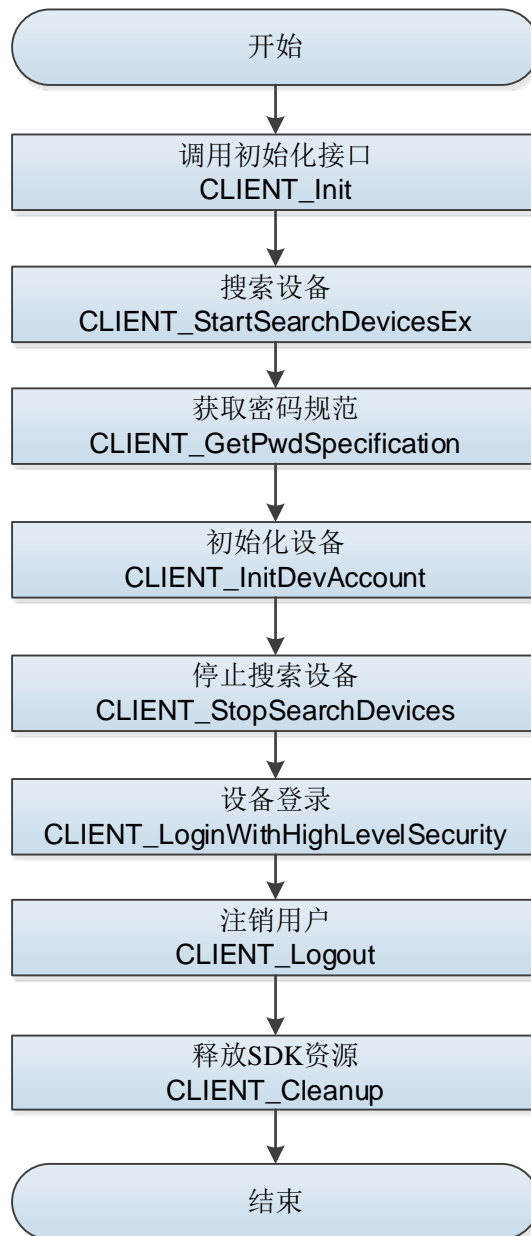
图2-2 设备初始化流程图
