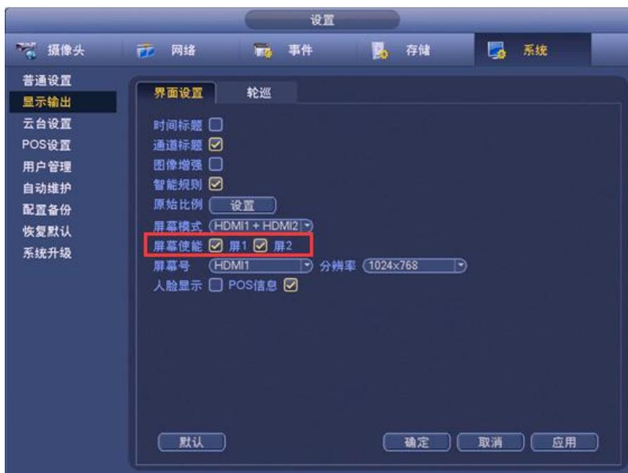
(2) 录像机主菜单-设置-系统-显示输出中勾选屏幕使能和选择 VGA+HDMI2 的画面分割数（以 DH-NVR4832-4K 为例）
